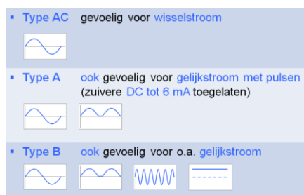
Figuur 6: Enkele types diff. en de soorten foutstroom waarvoor ze bedoeld zijn
